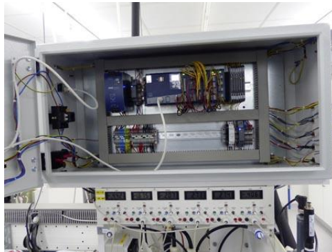
Bild : 2: sensors and automation "Made in Germany": Prüfstand für elektrochemische Sensoren der Reiss GmbH und JUMO-Gruppe
