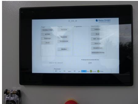
Bild 6 :: Alles im Blick - Der Anwender bekommt ein vollumfängliches Bild seines Anlagenzustands auf dem Webpanel
